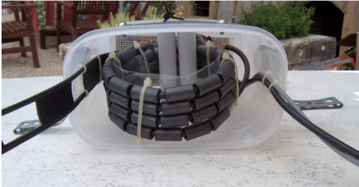
La boîte vue de dessous (avant montage). On distingue la platine au fond et le câble de contrôle des relais en gris à droite.
