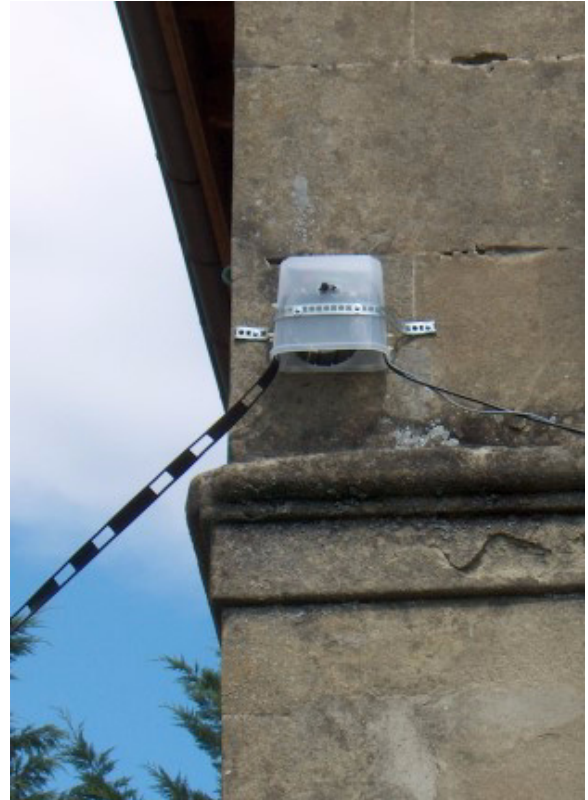
Les 2 circuits LC et les relais. La boîte montée contre la maison qui contient la platine électronique et le balun.
